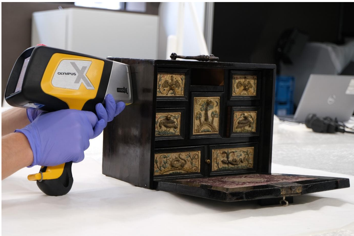
Figuur 3: De foto toont het uitvoeren van de chemische analyse met behulp portable-XRF om de materialen en technieken van het zwartgekleurde hout op dit 17de-eeuws kabinet te identificeren. Afbeelding © DIVA Antwerpen (inv. S58/66) © DIVA, Flynn Hermesen.
