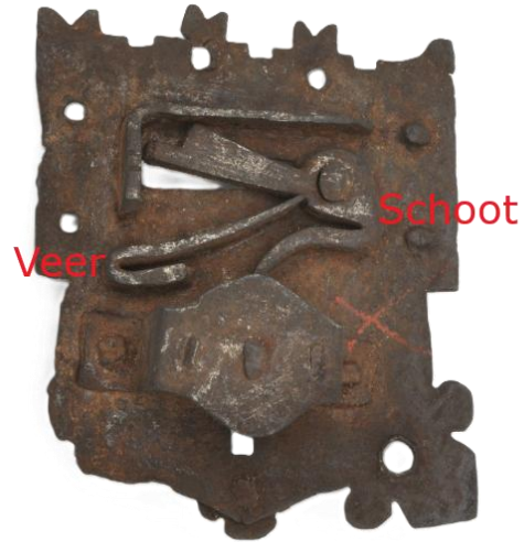
Voorbeeld van eenvoudig schootveerslot AV.2360 met een beweegbare schoot onder veerdruk. Foto © DAMS
