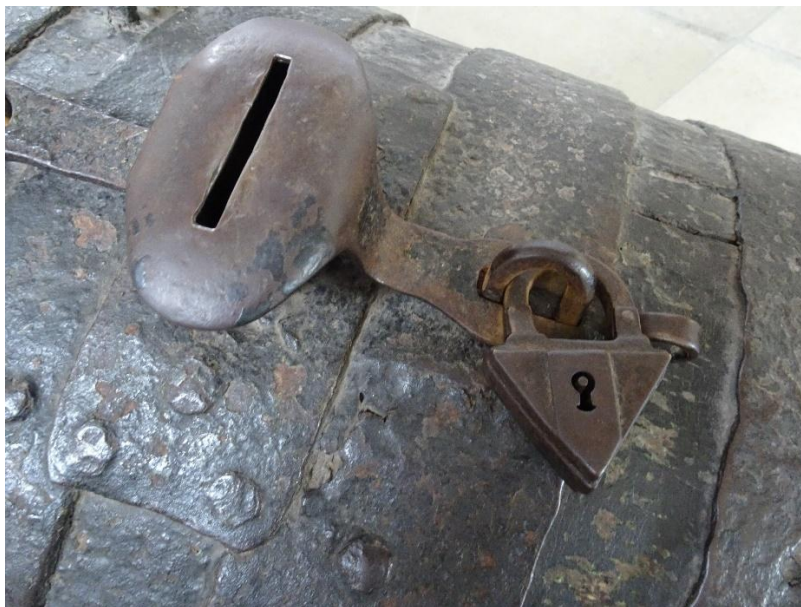
Driehoekig hangslot op een koffer voor donoren in het Heiligen-Geist-Hospital in Lübeck. De sleutel heeft een fijne baard in omgekeerde T-vorm.
